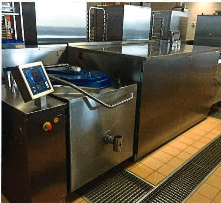
Ein Blick in die Küche des Klinikums Bad Hersfeld nach der Reorganisation durch CURATIS: moderne Küchentechnik mit Kochkessel inklusive Rückkühlung (li.) und Küchenblock mit Druckgarbraisierern (re.).
